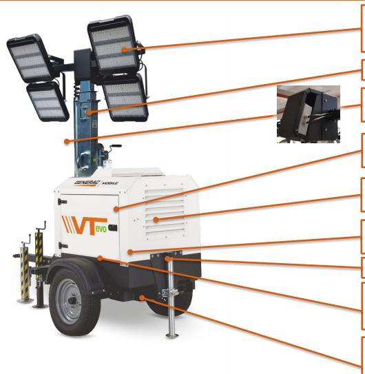
4x320W HEAVY DUTY G4 LED (LED POWER NO DRIVER) 188160 Lm - 147 lumen/watt
